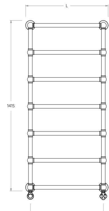
Termostato interamente realizzato in ottone con tubi Ø32 mm.
